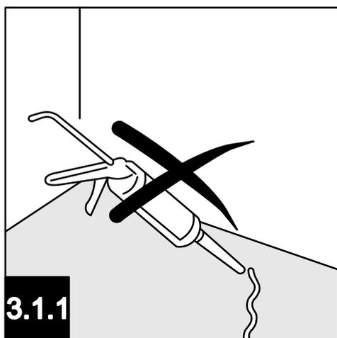
**Важно!** Запрещено частичное приклеивание или иное крепление SPC покрытия «Alta Step» к основанию, например, приклеивание по периметру или в отдельных зонах помещения. Запрещено укладывать SPC покрытие «Alta Step» под тяжелые неподвижные предметы. Такие, как кухонный гарнитур или стационарный шкаф-купе.
