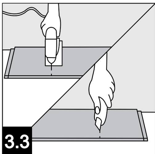
3.3. Для раскроя SPC «Alta Step», по прямой линии следует использовать специализированный строительный лезвийный нож. При помощи ножа прорежьте с лицевой стороны доски верхний защитный слой, затем согните доску по разрезу. Для выполнения фигурного раскроя следует использовать ручной или электрический лобзик.
